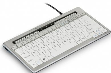
Grâce à son mécanisme de ciseaux, la frappe sur le clavier S board 840 est légère.
